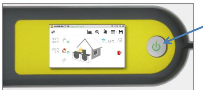
Afbeelding 15: A / UIT-schakelaar (zie pijl) Schakelaar licht op => voeding ingeschakeld (normaal bedrijf)
