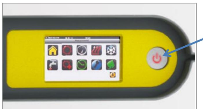
Afbeelding 22: A / UIT-schakelaar (zie pijl) Schakelaar licht op => voeding ingeschakeld (normaal bedrijf)
