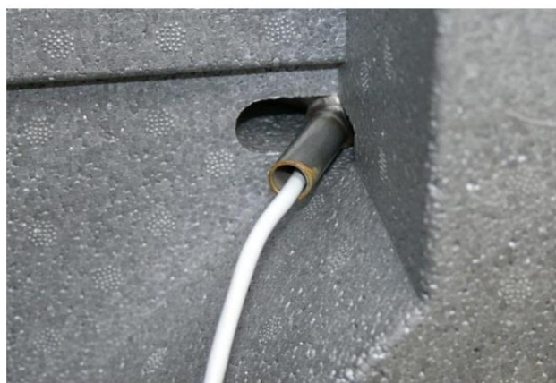
Afbeelding 15: Temperatuursensor zo ver mogelijk naar binnen gedrukt
