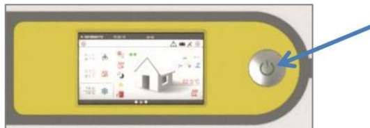
Figuur 8: A / UIT-schakelaar (zie pijl) Schakelaar licht op => voeding ingeschakeld (normaal bedrijf)
