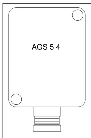
Afbeelding 6: Montagepositie van buitensensor
