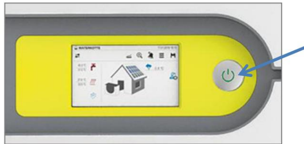
Afbeelding 7: EEN /UIT-schakelaar (zie pijl) Schakelaar licht op => voeding ingeschakeld (normaal bedrijf)
